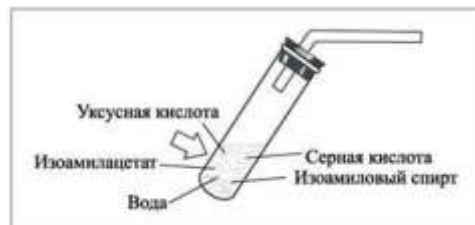
Рис. 1. Пробирка-реактор для получения сложного эфира (изоамилацетата)
